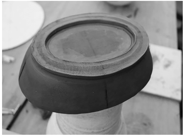
⑭ はがした後、隙間を埋め縁を整える
