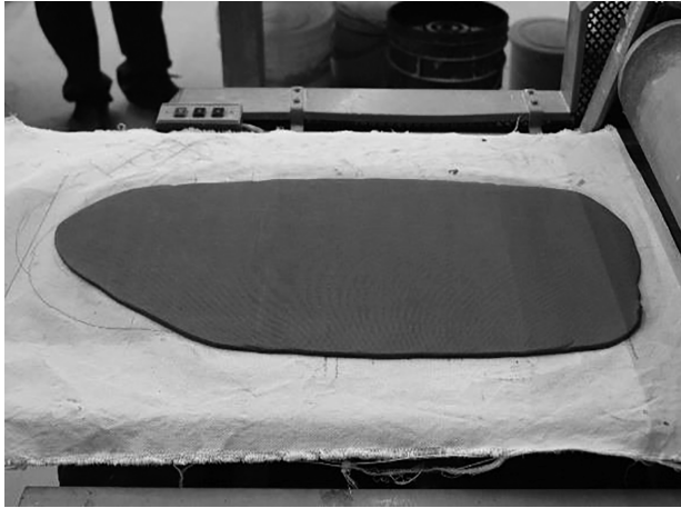
⑤ 電動タタラ板製造機（図1）によるタタラ板の作製
