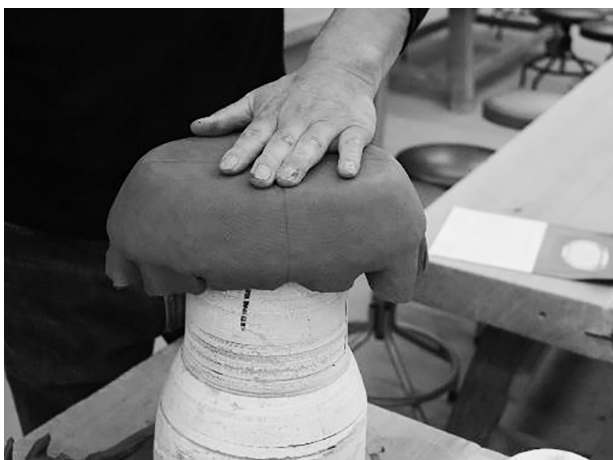
⑦ 型の上に押し付け形を整える
