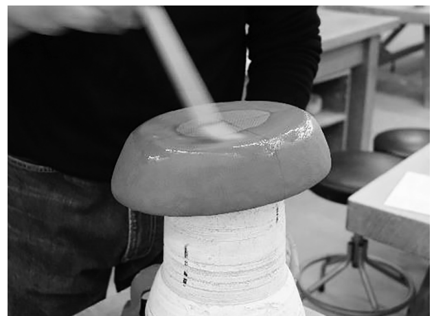
⑩ 底にドベ（泥状にした粘土）を塗る
