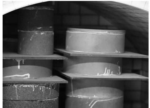
㉑ ガス窯 (図2) への窯詰め (さや詰め)
