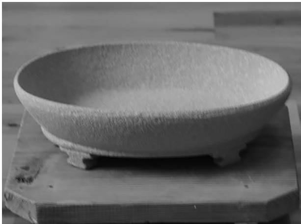
⑱ 素焼き後、釉掛け (スプレーガンによる吹付)
