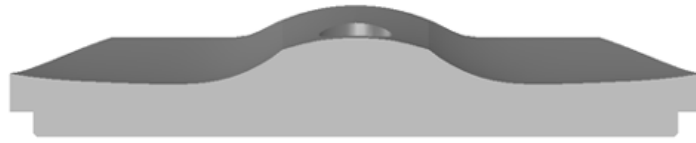
図5.8 CR型人工膝関節のポリエチレンインサートの冠状面断面
