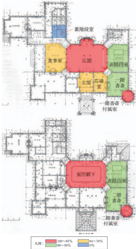
図6 対称軸を有する壁面の割合が高い部屋の配置 一階平面図(上)、二階平面図(下) (着色・加筆は著者による)
