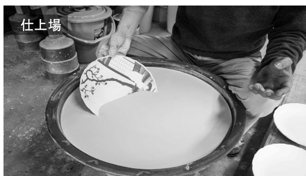
図11 施釉の様子（写真は染付を伴った作品）
